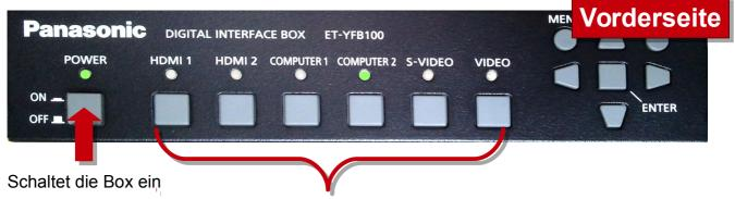
Zeigt an, welcher Eingang gerade an den Beamer übertragen wird, im Beispiel "Computer 2".
