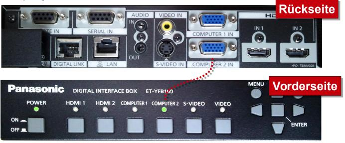
Wenn Sie Ihren eigenen Laptop beispielsweise an die Buchse "Computer 2 IN" angeschlossen haben müsssen Sie die Taste "Computer 2" an der Vorderseite drücken. Damit wird das Signal von Ihrem Laptop an den Beamer übertragen. Bitte beachten Sie, daß es bei jedem Tastendruck ein paar Sekunden dauern kann, bis die Box das Signal umgeschaltet hat.
